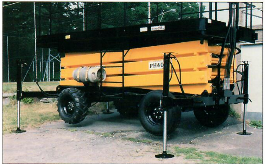
4 stabilisateurs hydrauliques indépendants / 4 independently operated, hydraulic outriggers
