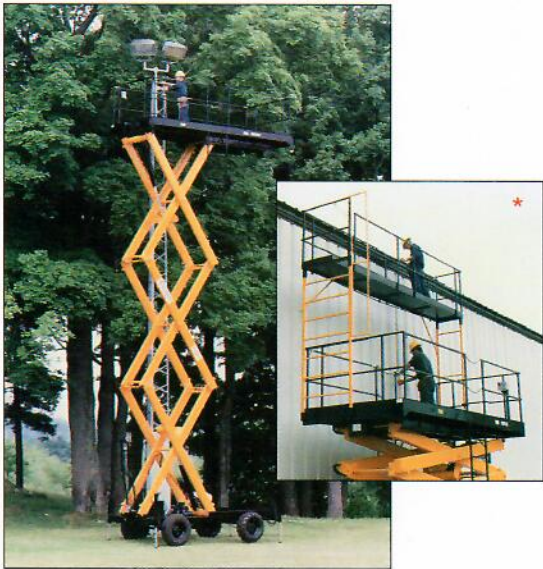
4 stabilisateurs hydrauliques indépendants / 4 independently operated, hydraulic outriggers
